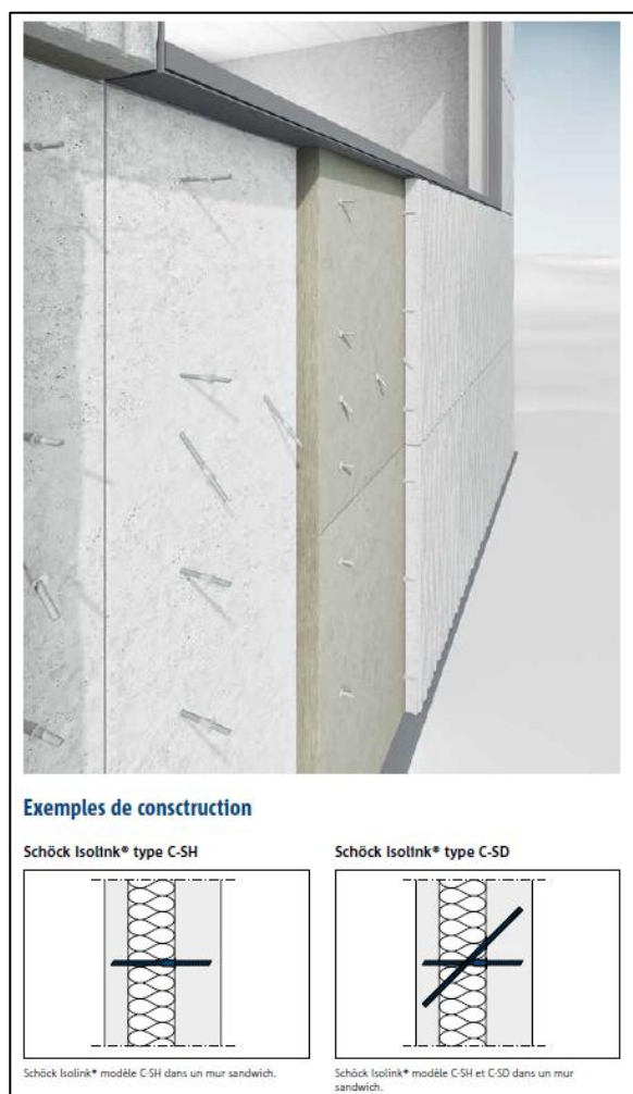
Figure 7- Photo et exemples de constructions intégrant la fixation SCHÖCK ISOLINK
